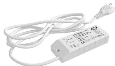
Der kurzschlussfeste Sicherheitstransformator kann problemlos beim Möbelbau zum Einsatz gebracht werden, da die MM-Kennzeichnung gegeben ist. Der Anschluss primärseitig und sekundärseitig erfolgt durch Schraubklemmen, welche für Kabel von 0,75mm<sup>2</sup> - 2,5mm<sup>2</sup> geeignet sind, wobei das Netzgerät primärseitig bereits mit einer 1,5m langen Eurozuleitung ausgestattet ist. Technische Daten: Versorgungsspannung: 220-240V/AC, ta: -20°C - 50°C, tc: 85°C, Powerfaktor: 0,80.
