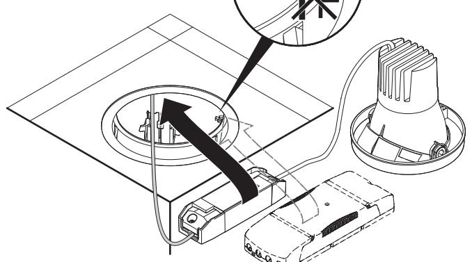
**EN** Protected earthing not required**DE** Erdung nicht erforderlich**FR** Mise à la terre dispensable**IT** Messa a terra non necessaria**NL** Bescherende aarde is niet vereist**SV** Skyddsjord krävs inte**FI** Suojamaadoitus ei tarvita**ES** Puesta a tierra no require**RU** Защищённое заземление не требуется
