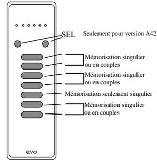
**TVEVO868A07/42 Fonction commandes avec touches séparées ouvre-stop-ferme**
