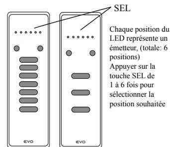
La sélection reste mémorisé jusqu'à la prochaine variation, aussi avec émetteur éteint; c'est suffisant de appuyer sur une touche canal pour réactiver la dernière sélection.
