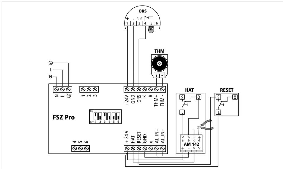
Abb. 29: Installation optionaler externer Handauslöse- und Resettaster
