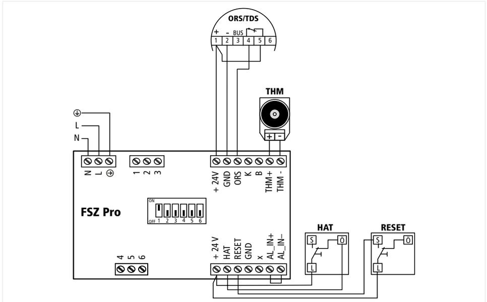
Abb. 22: Installation optionaler externer Handauslöse- und Resettaster
