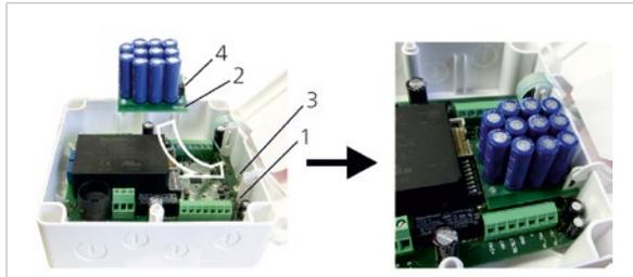
Abb. 15: ESM Pro einsetzen
