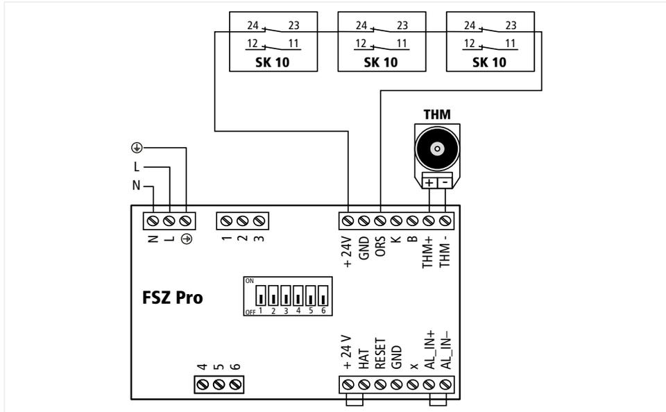
Abb. 21: Installation mit bis zu 3 Branderkennungselementen und 1 Feststellvorrichtung
