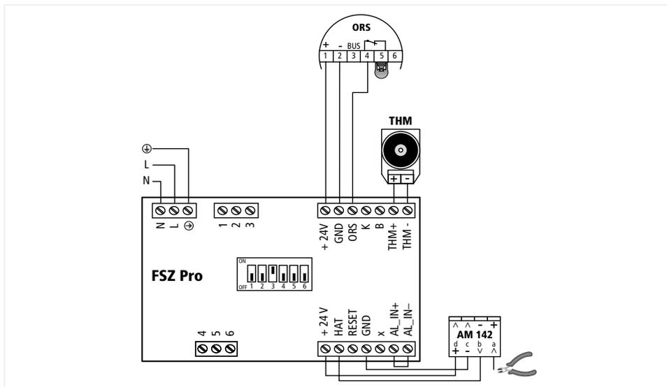
Abb. 25: Installation mit 1 Brandmelder ORS und 1 Feststellvorrichtung
