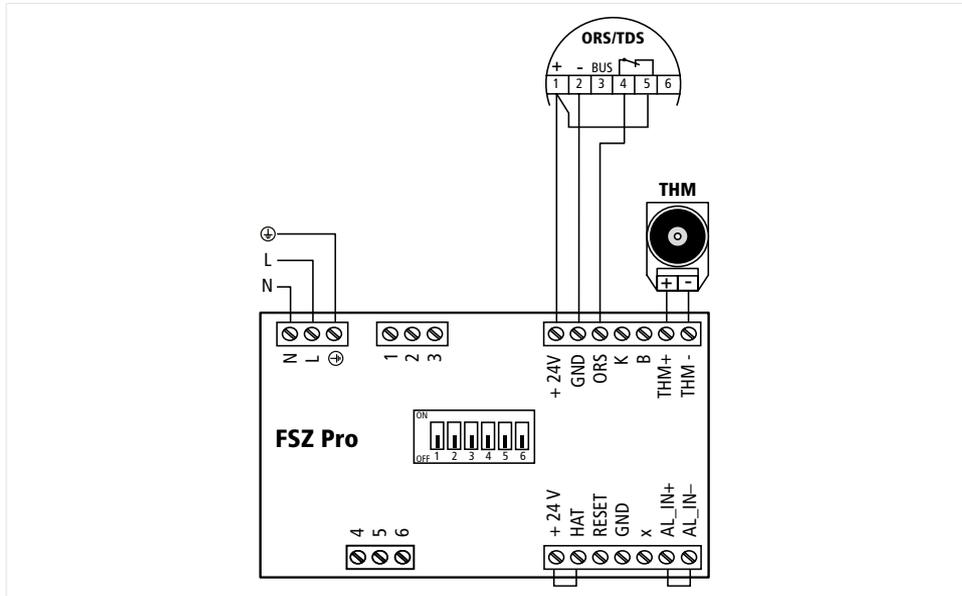
Abb. 19: Installation mit 1 Brandmelder und 1 Feststellvorrichtung
