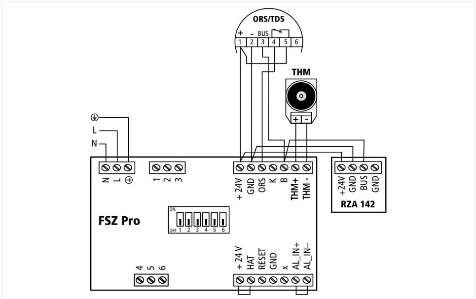
Abb. 24: Installation optionale Rauchschalter-Zustands-Anzeige
