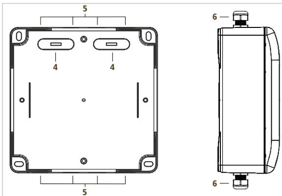
Abb. 6: Kabeleinführung vorbereiten
