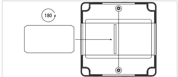
Abb. 13: Einschubstreifen drehen
