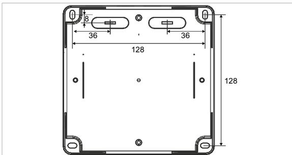
Abb. 4: Abmessungen für Montagelöcher (Angaben in mm)
