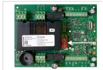
Abb. 9: DIP-Schalter auf der Platine
