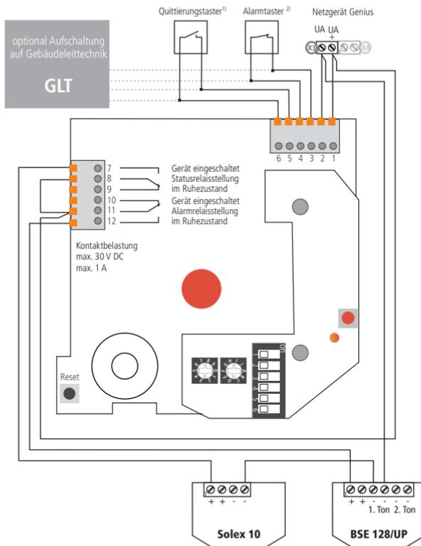
Abb. 4: Anschlussbeispiel mit optischem und akustischem Signalgeber
