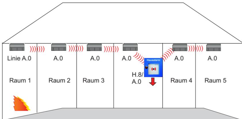
Der Funkhandtaster als Interface leitet das per Funk empfangene Signal drahtgebunden weiter (siehe Tab. 1 und Kapitel 6.2.2; DIP-Schalter 3 und 4 = ON)
