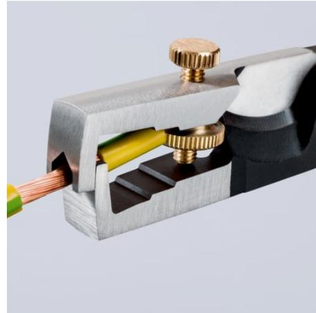
Induktiv gehärtete Scherschneide mit Präzisionsschliff zum quetschfreien Schneiden von Cu- und Al-Kabeln bis Ø 15 mm (5 x 2,5 mm<sup>2</sup>) Keine unabsichtliche Verstellung durch Sicherung mit Kontermutter
