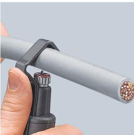
Ansetzen des Werkzeugs für Umfangsschnitt
