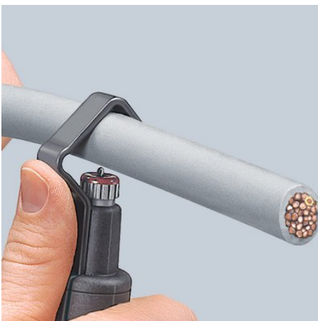
Ansetzen des Werkzeugs für Umfangsschnitt
