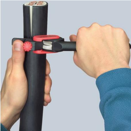
Drehen des Werkzeugs für Umfangsschnitt
