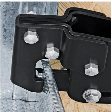
Das Stempelwerkzeug wird durch die Profilbleche gedrückt
