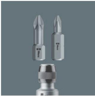
Wera Schnellwechselhalter stellen eine feste, wackelfreie Verbindung zwischen Halter und Bit her. Die Halter sind so konstruiert, dass beim Bitwechsel die äußere Hülse nach vorn geschoben wird und der Bit leicht eingesetzt und entnommen werden kann. In unmagnetischer Ausführung zur Verhinderung des ungewollten Anziehens von Metallspänen.
