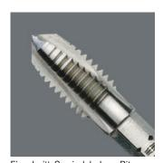
Einschnitt-Gewindebohrer-Bit Einsatz: Zum Schneiden von Gewinden • 1/4"-Antrieb passend für Halter nach DIN 3126-D 6,3 (ISO 1173) • Sehr gute Kraftübertragung durch Sechskant-Schaft • Fein abgestimmte Material- Elastizität für Sehr Standzeiten • Zentriereigenschaften Problemloses Schneiden Einwandfreie Spanabfuhr Geringe Verkantungsgefahr Präzise Rücklaufführung • Hoher Korrosionsschutz
