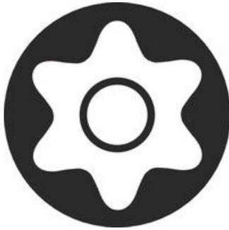
Durch den vorstehenden Zapfen (die Schraube ist mit einer Bohrung versehen) wird die Zentrierung des Werkzeugs in der Schraube leichter gemacht.
