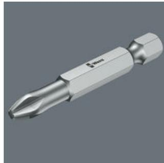
TZ-Bits sind zähnharte Bits mit Torsionszone. Torsion-Bits sorgen für die Abfederung von Drehmomentspitzen in der Torsionszone. Dadurch wird vorzeitiger Verschleiß vermieden, die Lebensdauer des Bits wird erhöht.
