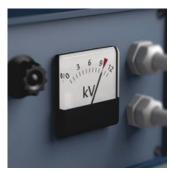
Die Prüfung des Werkzeugs auf Durchschlagsfestigkeit bei 10.000 Volt gibt dem Anwender die beruhigende Gewissheit, dass sein Schraubendreher auf seine wichtiaste Eigenschaft, die Isolation, geprüft worden ist. Wera VDE-Schraubendreher werden Stück für Stück dieser Prüfung unterzogen. Sicheres Arbeiten bis 1.000 Volt ist somit garantiert.
