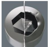
Innensechskantschrauben sind problematisch, die denn Anlageflächen, über die die Kraft vom Werkzeug auf die Schraube übertragen wird, sind sehr schmal. Die Folge: Der Schraubenkopf kann zerstört werden. Hex-Plus Werkzeuge haben größere Anlageflächen, die diese Gefahr verringern. Gut zu wissen: Hex-Plus Werkzeuge passen in jede Sta ndard-Innensechskantschraube!
