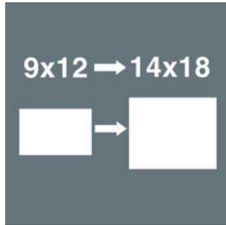
Für die Verwendung von Einsteckwerkzeugen mit Außenvierkant 14x18 mm in Drehmomentschlüsseln mit Innenvierkant 9x12 mm.
