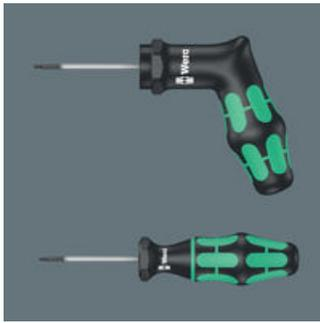
Die Wera Drehmomentindikatoren sind werkseitig mit den von führenden Hartmetallwerkzeugherstellern empfohlenen Werten voreingestellt. Diese Anzugswerte sind für TORX®, TORX PLUS® und Innensechskantschrauben auf die jeweilige Schraubengröße bezogen. Drehmomentindikatoren sorgen für sichere und leicht lösbare Schraubverbindungen. Präzision: ± 10 %
