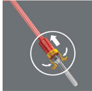
Schraubkralle weiter in Richtung Schraubendrehergriff ziehen, bis sich die beiden Arme des Schraubengreifers an den Schraubenkopf anlegen und leicht aufspreizen. Die Wera-Schraubkralle gibt die Schraube nach dem Schraubvorgang automatisch frei!
