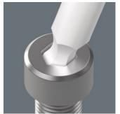
Durch die kugelförmigen Abtriebsprofile ist ein Auslenken oder Schwenken der Werkzeugachse zur Schraubenachse möglich, so dass dadurch sozusagen "um die Ecke" geschraubt werden kann.
