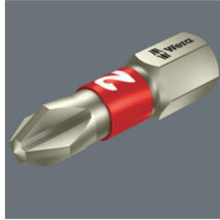
Durch den Einsatz von Edelstahl-Bits wird die Entstehung von Rost auf Edelstahl-Schrauben oder Edelstahl-Oberflächen vermieden. Fremdrost auf Edelstahl entsteht vorwiegend durch Abrieb beim Verschrauben mit herkömmlichen Stahlwerkzeugen. Der Abrieb hinterlässt festhaftende Stahlpartikel, die unter Einwirkung von Sauerstoff zu Rost werden.
