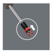
Schraubkralle auf die Klingenspitze des Schraubendrehers schieben bis das Klingenprofil aus der Gummi-Klingenaufnahme heraustritt.
