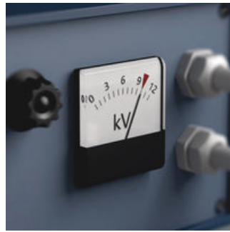
Die Stückprüfung der Zyklop Werkzeuge für Elektriker bei 10.000 Volt gemäß IEC 60900 garantiert sicheres Arbeiten unter Spannung bis 1.000 Volt.
