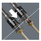
Impaktor Der Halter mit Ringmagnet hält zusätzlich lange und schwere Schrauben bombenfest. Damit ist ein blitzschnelles und sicheres Ansetzen der Schraube möglich. Ideal auch für Über-Kopf Arbeiten. Sollte der Magnet situationsbedingt, Z. В. bei Metallarbeiten, nicht gewünscht sein, kann er aus dem Schraubbereich herausgezogen und damit "ausgeschaltet" werden. Einsatz vorwiegend bei manuellen Maschinenverschraubungen.
