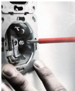
Unerlässlich für den Einsatz bei Reihenklemmen, Sicherungskästen, Schaltern, Relais etc.: Die Profilkombination aus Schlitz und Phillips bzw. Schlitz und Poqidriv.
