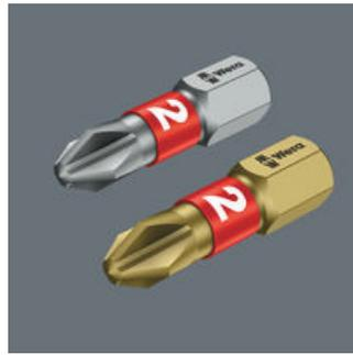
BTH- (harte Ausführung) und BTZ-Bits (zähnharte Ausführung) haben eine angelassene BiTorsion-Zone, wodurch die Härte des Schaftes um ca. 20 % gegenüber der Abtriebsspitze reduziert wird. Dadurch wird das Verwinden der Bitspitze bei auftretenden Belastungsspitzen vermieden, was die Lebensdauer des Bits noch weiter erhöht.
