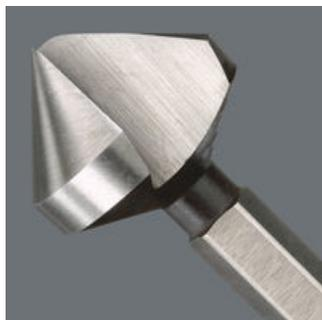
1-nutiger Kegelsenker-Bit, 90° • Einsatz: Entgraten und Senken • 1/4"-Antrieb passend für Halter nach DIN 3126-D 6,3 (ISO 1173) • Sehr gute Kraftübertragung durch Sechskant-Schaft • 1 Schneide • Garantiert ratterfreies und riefenfreies Arbeiten • Beste Oberflächengüte der Senkung • Hohe Standzeit • Einwandfreie Spanabfuhr • Hoher Korrosionsschutz
