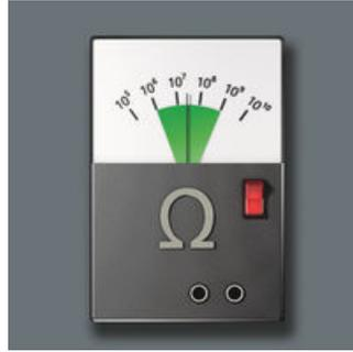
Der elektrische Oberflächenwiderstand des Wera ESD Materials liegt bei  $\leq 10^9$  Ohm. So werden Bauteile vor elektrostatischer Energie und damit verbundenen Schäden sicher geschützt.
