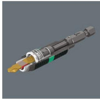
Die Wirkungsweise des BiTorsion-Systems basiert auf der Kombination von zwei schockabsorbierenden Feder-Elementen. Sowohl Bits als auch Halter weisen eine federnde Torsionszone auf, die bei Belastungsspitzen kinetische Energie aus der Abtriebspitze ableitet.
