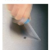
Immer wieder passiert es, dass man beim Verschrauben aus der Schraube rutscht. Manchmal dabei werden wertvolle Oberflächen beschädigt oder man verletzt sich sogar. Die Spitze von Wera Lasertip-Schraubendrehern wird mit Laserstrahlen aufgeraut. mikroskopisch fein Diese raue Oberfläche "beißt" sich förmlich im Schraubenkopf fest. Das unbeabsichtigte kann Herausrutschen damit vermieden werden.
