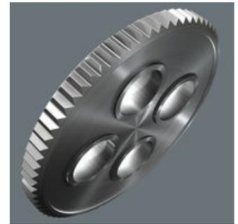
Die mit 72 Zähnen feinverzahnten Umschaltnarren haben einen niedrigen Rückschwenkwinkel von nur 5°. Der kleine Hub ermöglicht schnelles und präzises Arbeiten in allen Einbaulagen.
