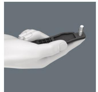
Die 1/4" Sechskantaufnahme im Reifenheber 9502 erlaubt die Fixierung französischer Ventile an den seitlichen Abflachungen. Zudem kann ein 1/4" Bit eingesetzt und so leichte Verschraubungen vorgenommen werden.
