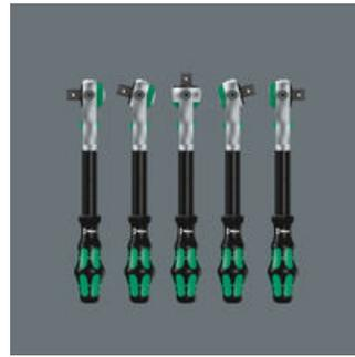
Der Knarrenkopf ist frei schwenkbar und kann durch den beidseitig angebrachten Schiebeshalter in jeder Fixierungsposition verriegelt werden. Problemloses Arbeiten mit großem Handfreierraum ist selbst in sehr engen oder schwer zu erreichenden Einbausituationen möglich. Die definierte Fixierung bei 0°, 15° und 90° nach links und rechts garantiert sicheres Arbeiten ohne Verrutschen des Knarrenkopfes.
