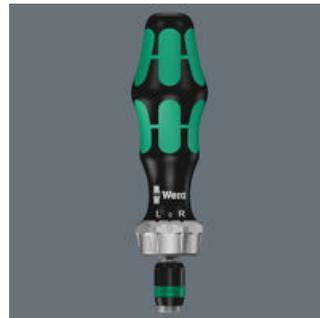
Ratschenschraubendreher, Feinverzahnung für geringen Rückholwinkel, Umschaltring (rechts, fest, links), maximales Drehmoment von bis zu 50 Newtonmetern; 1/4"-Innensechskantaufnahme mit Rapidaptor-Technologie mit rapid-in, rapid-out, rapid-spin, chuck-all und single-hand-Funktion für blitzschnellen Bit-Wechsel, magnetisch, geeignet für Bits mit 1/4"-Außensechskantantrieb nach DIN ISO 1173-C 6,3 und E 6,3 und Wera Anschluss-Reihen 1 und 4
