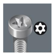
Konstruiert, um unerlaubtes Lösen von sogenannten Sicherheitsverschraubungen zu verhindern. Um eine Verwendung "normaler" TORX® Werkzeuge nicht zuzulassen, besitzen die Schrauben in ihrem Antriebsprofil einen vorstehenden Zapfen. Dieser wird in der Bohrung der TORX® BO Werkzeuge aufgenommen und die Sicherheitsverschraubung kann gelöst werden.
