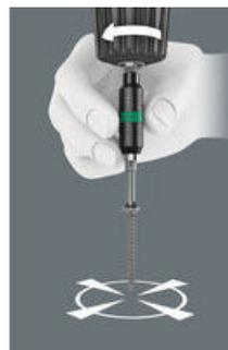
Die freilaufende Betätigungshülse erlaubt dem Anwender, den Akku- oder Elektroschrauber während des Schraubvorgangs an der Hülse zu führen. Das erleichtert das Ansetzen in der Schraube und verhindert Abrutschen. Auch als kurze Verlängerung bei 1/4" Anwendungen verwendbar z. B. in Kombination mit Wera Zyklop Knarren.
