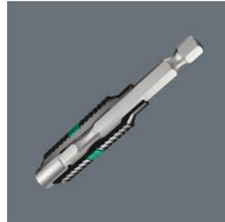
BiTorsion-Halter von Wera haben eine Torsionfeder, die kleinere Belastungsspitzen beim Verschrauben aufnimmt. Der gemeinsame Einsatz mit BiTorsion-Bits und ihrer Torsions-Zone verlängert die Standzeit des Werkzeugs deutlich. BiTorsion-Halter von Wera können aber auch mit konventionellen Bits eingesetzt werden.
