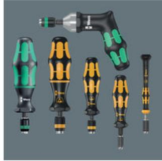
Wera Drehmomentschraubendreher. Mit werkseitig fest auf den kleinsten Skalenwert voreingestelltem Drehmomentwert. Für alle Anwendungen, bei denen konstant dasselbe Drehmoment benötigt wird und Wiederholgenauigkeit gefordert ist. Der Drehmomentwert kann mit einem Extra-Werkzeug innerhalb des Messbereichs verändert werden (Re-Kalibrierungs-Kit, bestellbar mit der Codenummer 05137001001). Danach mit einem handelsüblichen Drehmomentprüfgerät den eingestellten Wert überprüfen.
