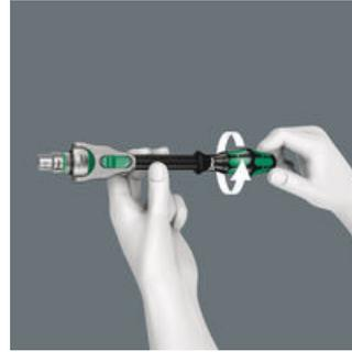
Die Zyklus Speed-Knarren sind echte Schnelldreher: Die Schwungmassen-Konstruktion sorgt für die Beschleunigung des Schraubprozesses. Der rotationssymmetrische Aufbau des Kraftform-Griffs und die Freilaufhülse unterstützen das rasante Zwirbeln. Insbesondere dann, wenn durch ein zu leichtgängiges Gewinde die Knarre noch nicht greift.
