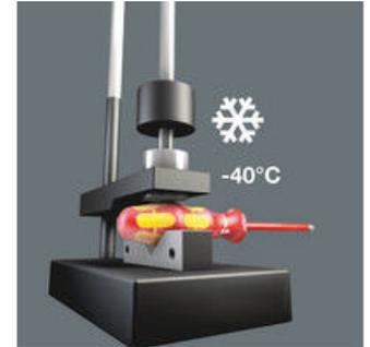
Auch bei extremen Einsatzbedingungen ist durch die geprüfte Kaltschlagfestigkeit bei -40 °C die Sicherheit gewährleistet.
