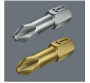
Torsion-Bits sorgen für die Abfederung von Drehmomentspitzen in der Torsionszone. Dadurch wird vorzeitiger Verschleiß vermieden, die Lebensdauer des Bits wird erhöht.
