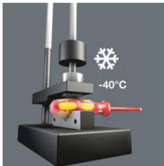
Auch bei extremen Einsatzbedingungen ist durch die geprüfte Kaltschlagfestigkeit bei  $-40^{\circ}\text{C}$  die Sicherheit gewährleistet.
