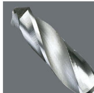
Spiralbohrer-Bit – für Metall-Anwendungen • 1/4"-Antrieb passend für Halter nach DIN 3126-D 6,3 (ISO 1173) • Sehr gute Kraftübertragung durch Sechskant-Schaft • HSS = Hochleistungsschnell-Stahl mit Kreuzanschliff • Fein abgestimmte Material- Elastizität für hohe Standzeiten • Sehr gute Rundlaufgenauigkeit • Zähnharte vergütete Bits für besonders lange Lebensdauer
