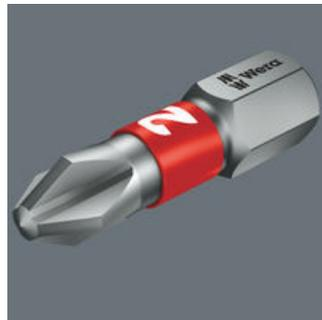
BiTorsion Bits sind absolute Premium-Bits. Mit weicherer BiTorsion-Zone, wodurch die Härte des Schaftes um ca. 20 % gegenüber der Abriebsspitze reduziert wird. Dadurch wird das Verwinden der Bitspitze bei auftretenden Belastungsspitzen größtenteils vermieden, was die Lebensdauer des Bits noch weiter erhöht.
