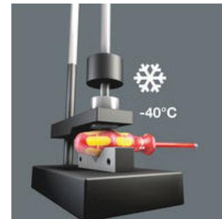
Auch bei extremen Einsatzbedingungen ist durch die geprüfte Kaltschlagfestigkeit bei  $-40\text{ }^{\circ}\text{C}$  die Sicherheit gewährleistet.
