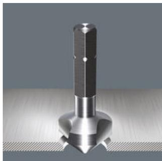
3-nutiger Kegelsenker-Bit, 90° • Einsatz: Zum Entgraten, Fasen, Senken • 1/4"-Antrieb passend für Halter nach DIN 3126-D 6,3 (ISO 1173) • Sehr gute Kraftübertragung durch Sechskantschaft • HSS = Hochleistungsschnell-Stahl • Fein abgestimmte Material- Elastizität für hohe Standzeiten • 3 Schneiden • Sehr gute Zentriereigenschaften • Problemloses Schneiden • Einwandfreie Spanabfuhr • Geringe Verkantungsgefahr • Präzise Rückaufführung • Hoher Korrosionsschutz
