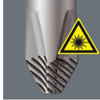
Mittels eng fokussiertem Laserlicht wird eine scharfkantige Oberflächenstruktur erzeugt. Die Laserbehandlung bewirkt eine Härte der Spuren von bis zu 1000 HV 0,3. Wera Lasertip krallt sich im Schraubenkopf fest und verhindert das Herausrutschen aus dem Schraubenkopf. Bei Schlitz, Phillips und Pozidriv.
