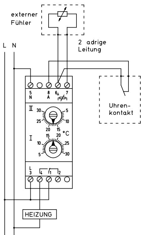
**Beispiel Raumheizungsregler: Temperaturabsenkung mit Schaltuhr**
