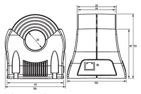
Maßzeichnung Differenzstrommonitore e.Guard RCM B  ${\rm o}_{35}$
