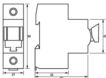
Mazeichnung Sicherungslasttrennschalter Tytan II Do-25-1/S
