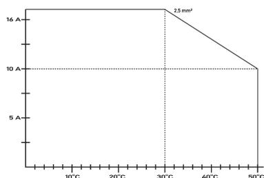
Diagramme Dämmerungsschalter Dasy 016-2 230 V - we
